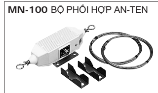
Phối hợp máy thu phát với an-ten lưỡng cực. Bao trùm toàn bộ dải tần HF từ 1.5 đến 30 MHz. An-ten dây 8 m × 2 được gắn.
